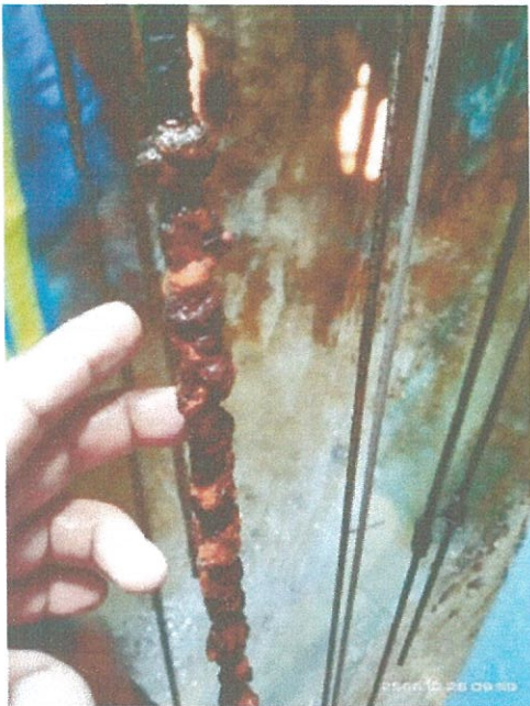
ภาพก้านวัดระดับน้ำที่มีปัญหาสนิมเหล็ก
